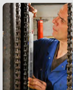
Messung der Kettenlänge
